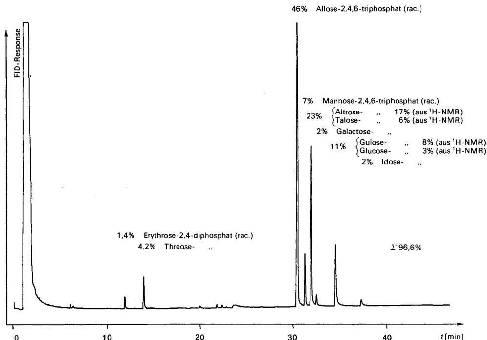
Fig. 3. GC des Produktgemisches der Aldomerisierung von **2** (Bedingungen B; Exper. b in Tab. 3). Aufnahme nach Entphosphorylierung, Reduktion und Acetylierung zu den Triteritol- und Hexitol-acetaten (s. Schema 4)\*).
