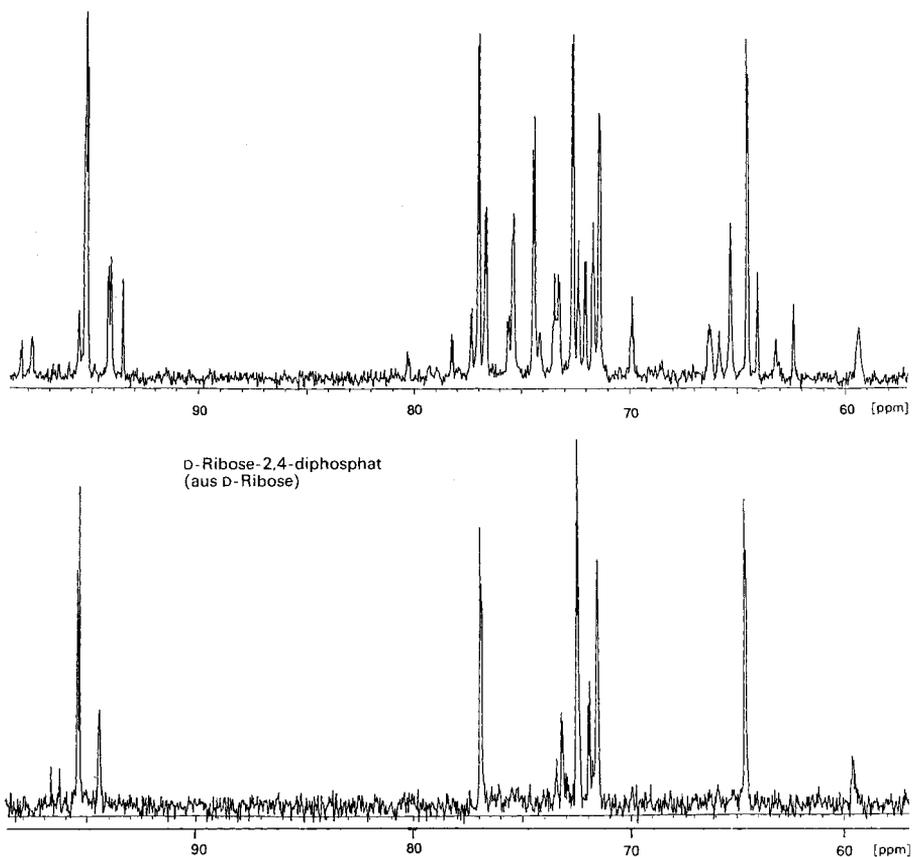
Fig. 11.  $^{13}\text{C}$ -NMR-Spektren (75 MHz,  $\text{D}_2\text{O}$ ) des Gemisches der *rac*-Pentose-2,4-diphosphate nach Ionenaustausch- und Polyacrylamidgel-Chromatographie, im Vergleich zum Spektrum von D-Ribose-2,4-diphosphat<sup>17)</sup>\*)
