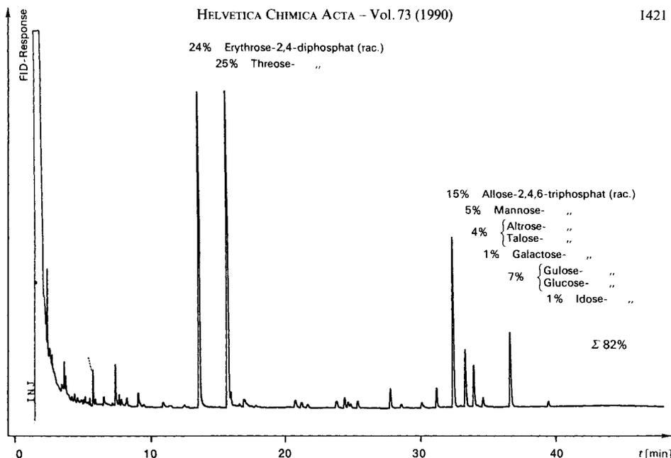
Fig. 4. GC des Produktgemisches der Aldomerisierung von **2a** (Bedingungen C; s. Schema 3). Aufnahme nach Entphosphorylierung, Reduktion und Acetylierung zu den Triteritol- und Hexitol-acetaten (s. Schema 4)\*).
