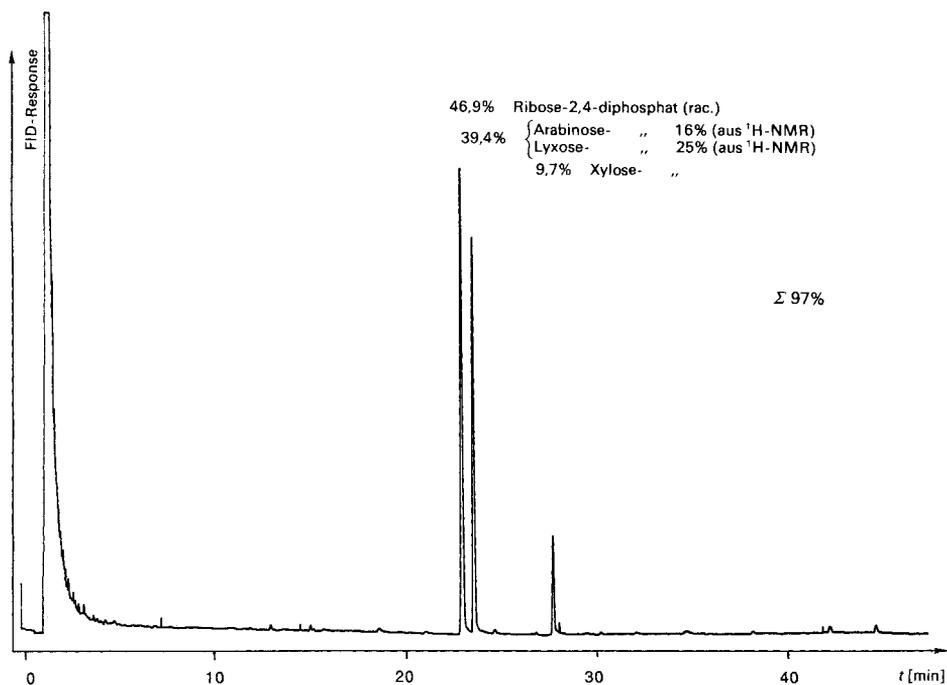
Fig. 12. GC der Pentose-diphosphat-Fraktion der Aldolisierung von **2** mit Formaldehyd, erhalten nach Ionenaustausch- und Polyacrylamidgel-Chromatographie sowie Entphosphorylierung, Reduktion und Acetylierung\*)
