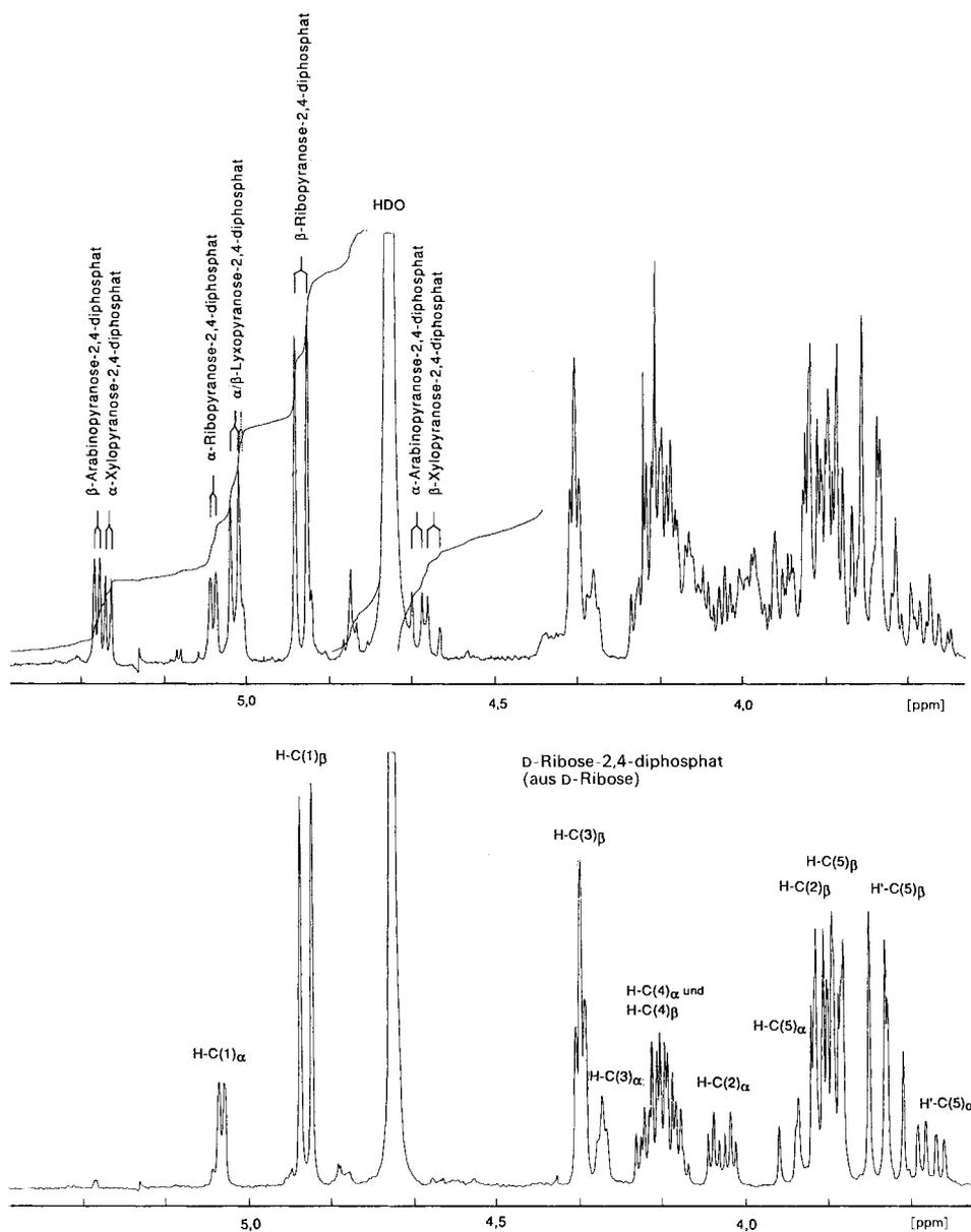
Fig. 10. <sup>1</sup>H-NMR-Spektrum (300 MHz, D<sub>2</sub>O) des Gemisches der *rac*-Pentose-2,4-diphosphate nach Ionenaustausch- und Polyacrylamidgel-Chromatographie, im Vergleich zum Spektrum von D-Ribose-2,4-diphosphat<sup>17)</sup> \*)
