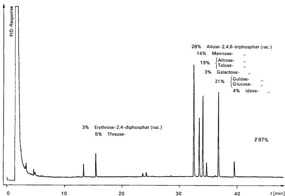
*Fig. 2. GC des Produktgemisches der Aldomerisierung von 2a (Bedingungen A; s. Schema 3 und Exper. c in Tab. 1). Aufnahme nach Entphosphorylierung, Reduktion und Acetylierung zu den Tetritol- und Hexitol-acetaten (s. Schema 4)\*)*
